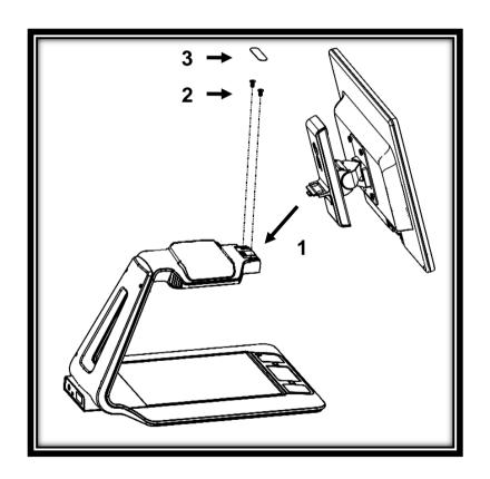
4. Connectez le câble DC au port DC (1). Ensuite, insérez le câble DVI dans le port DVI et serrez les 2 vis inclues (2). Utilisez le serre-câble pour attacher les câbles derrière l'écran (3).
